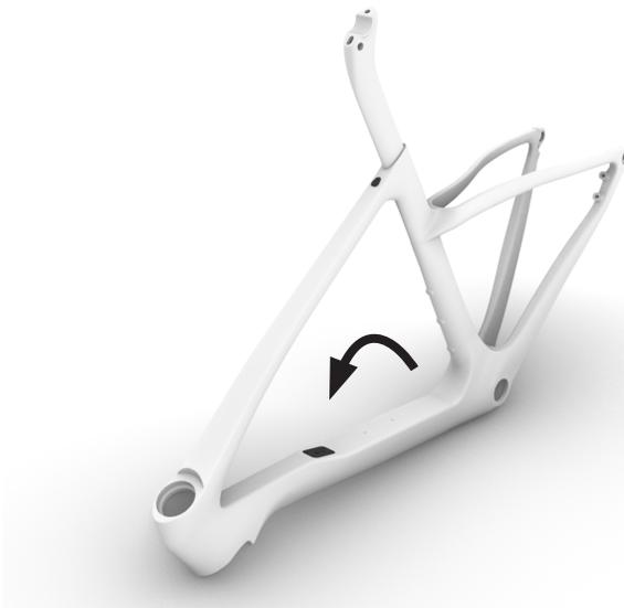
2. Svitare il grano e rimuovere il reggisella eseguendo la stessa procedura indicata dalle istruzioni n°1. Se si mantiene costantemente l'inclinazione, la vite M6 non sarà necessaria.
